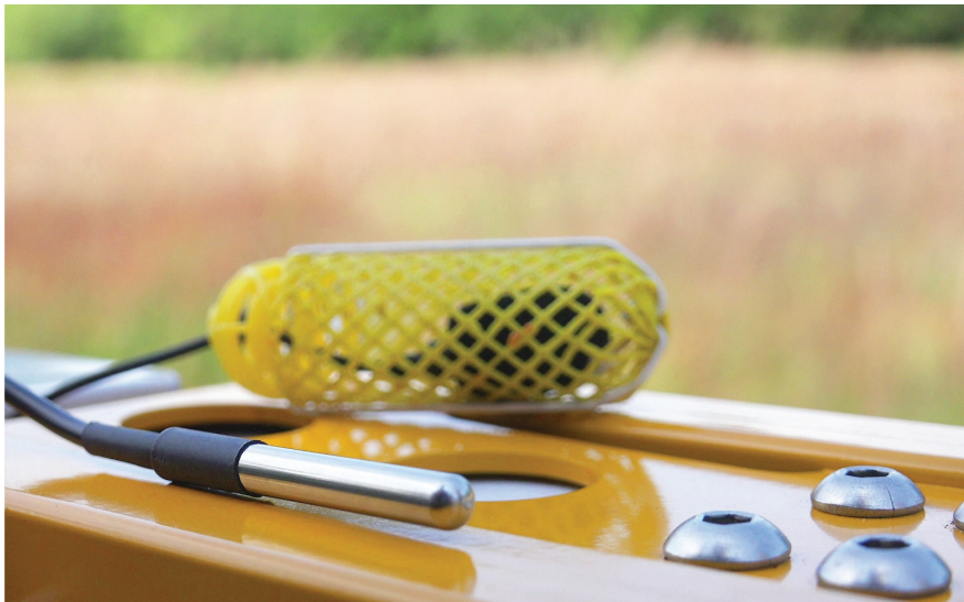
✧ De microfoon en temperatuursensor van de BEEP base worden in de bijenkast gehangen (foto: Robert Zwart).
